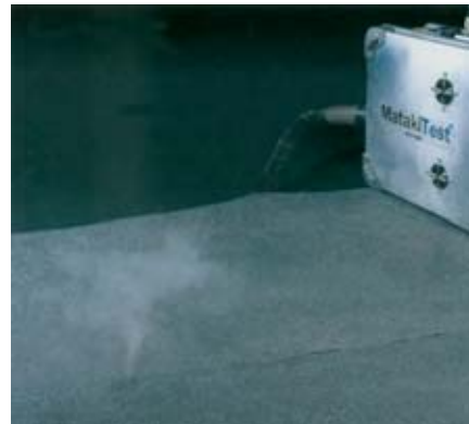
MATAKI DŪMŲ TESTAS LEIDIA PATIKRINTI PLOKŠČIO STOGO KOKYBĘ, KAI DENGIAMA MECHANIŠKAI TVIRTINAMA DANGA.
